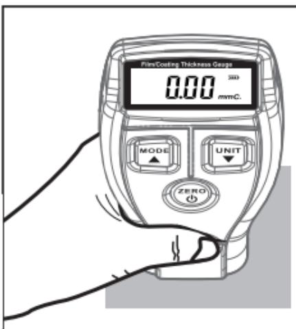
**d:** Trek de detector terug, het display toont 0.05mm. Start nu de tweede ijking door het ijk-folie 0.05mm op het metalen substraat te leggen, en druk lichtjes de detector op het substraat. Na 2 PIEP-PIEP tonen is het tweede ijkpunt voltooid.
