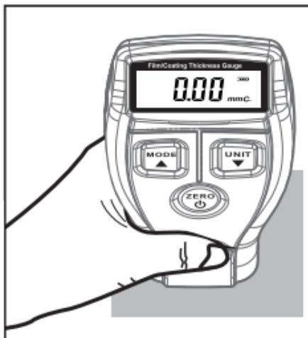
**d:** Retirer le détecteur, et l'afficheur affiche 0.05mm. Commencez maintenant la seconde calibration en posant le film de calibration 0.05mm sur le substrat métallique et pressez légèrement le détecteur sur le substrat. Après 2 sons BIP-BIP, le second point de calibration est terminé.
